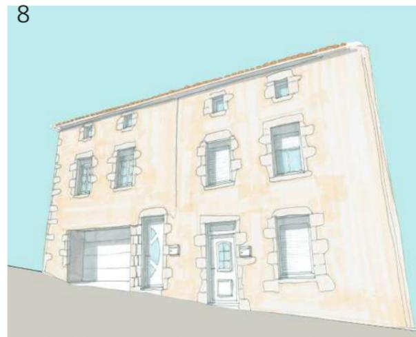
La réalisation d'un enduit ciment peint en surépaisseur et mise à nu des pierres d'encadrement de manière aléatoire
